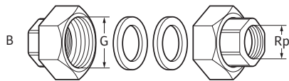
Abb. A: Spezialeinlege­teile mit Whitworth­­Außengewinde (DIN EN 10226-1) und Innenbohrung für den wahlweisen Anschluss mit Gewinde oder mit Lötverbindung an Kupferrohr (DIN EN 1057)
